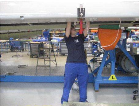
Raceways – Kabel einziehen
