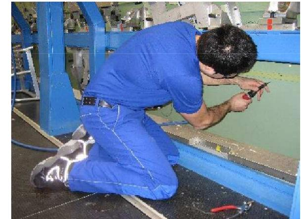
Aufbohren der Vorbohrlöcher in der Endkante
